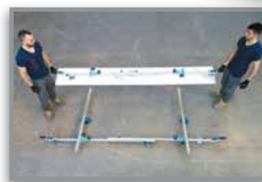
Traversi smontabili per lastre strette Dismontable for small slabs
