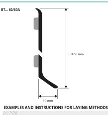
USE PROBAND FIX FOR FIXING THE PROFILE TO THE WALL
