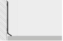
USE PROBAND FIX FOR FIXING THE PROFILE TO THE WALL
