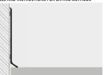
USE PROBAND FIX FOR FIXING THE PROFILE TO THE WALL
